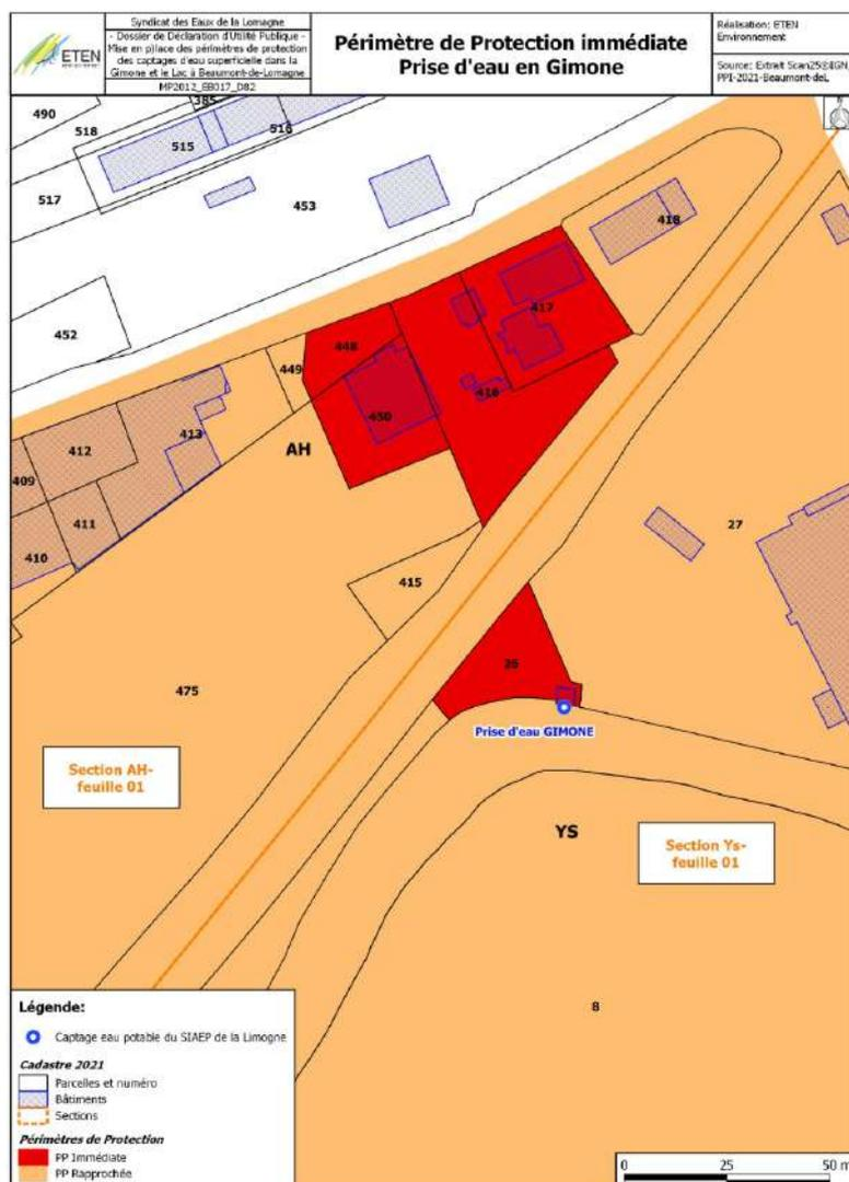
Pour ce périmètre immédiat du captage de la Gimone, il est préconisé le renforcement du grillage côté station-service et aire de lavage ainsi que la mise en place d'un muret étanche et un dispositif de collecte des eaux de ruissellement.
